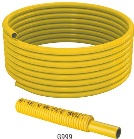
Il tubo multistrato G999 è costituito da uno strato interno di PEX-b (polietilene reticolato), uno strato intermedio di alluminio, saldato longitudinalmente (testa-testa) con tecnologia laser/TIG e uno strato esterno di PEX-b di colore giallo. Gli strati intermedi di collante uniscono in modo omogeneo lo strato di alluminio agli strati di PEX-b. Il tubo multistrato G999 è idoneo al trasporto di gas ad uso domestico.
